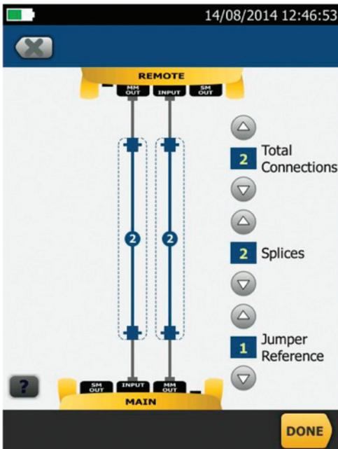
Una vez seleccionado el número correcto para cada elemento, seleccione DONE (Hecho) y volverá a la pantalla TEST SETUP (Configuración de la prueba).
